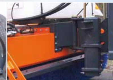
Aufnahmesystem mit Rahmen verschraubt
