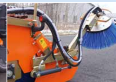
hydraulisch klappbarer Seitenkehrbesen
