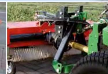
mechanischer Antrieb für Drehzahlen von 540 bis 2100 /min
