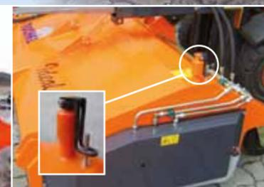
Einfache Bürstennachstellung der pendelnd aufgehängten Kehrwalze über Handkurbel
