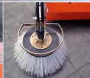
Seitenkehrbesen hydraulisch angetrieben
