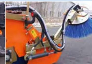
hydraulisch klappbarer Seitenkehrbesen
