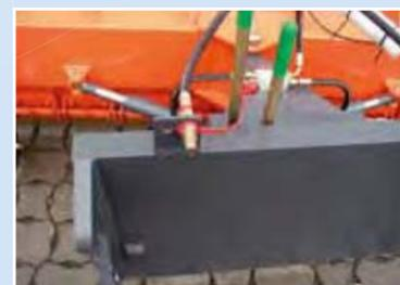
Hydraulische Seitenverstellung über doppelt wirkenden Steuerkreis optional
