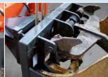
Anbau an verschiedene Trägerfahrzeuge möglich, hier über Radladeraufnahme
