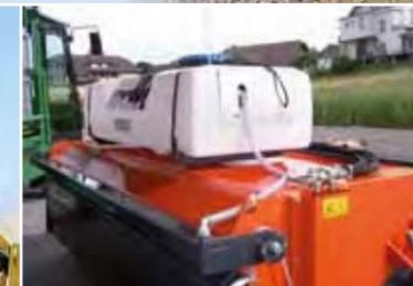
Wassersprüheinrichtung mit 100/200 Liter Wassertank
