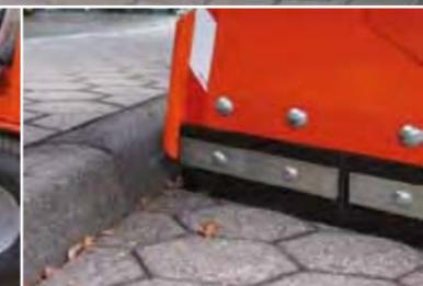
Randabweiser und Federklappensystem schützen vor Beschädigungen
