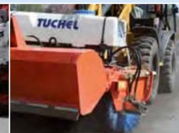
Staubbindung durch Wassersprüheinrichtung, Freikiehrmodus serienmäßig
