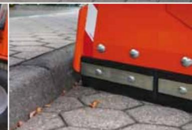
Randabweiser und Federklappensystem schützen vor Beschädigungen
