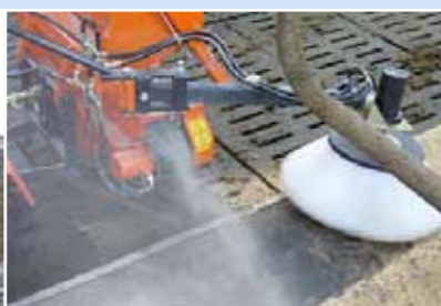
Spalten abschieben – Boxen abfegen und Einstreuen in einem Arbeitsgang
