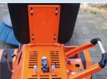
Sitz mit Kontaktschalter, Elektrostarter, Antriebshebel Zusatzhydraulik, hydraulische Aushebung
