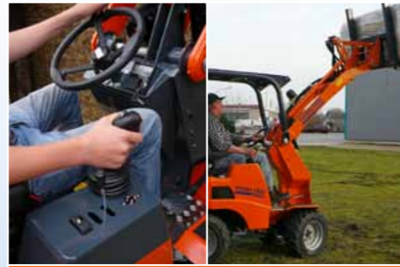
Bedienung mit nur einer Hand per Joystick
