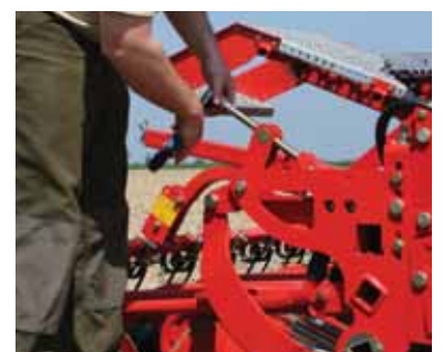
Die mechanische Scharldruckverstellung ist Standard, die hydraulische Version ist optional erhältlich
