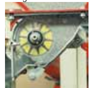
Einstellung für feines Saatgut (Kern eingeschoben)
