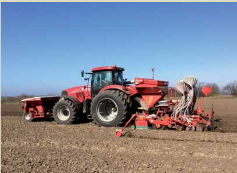
i-drill PRO in Kombination mit dem DF-1 Fronttank. Das Saatgut befindet sich im i-drill PRO Tank während der Mineraldünger aus dem DF-1 Fronttank ausgebracht wird.
