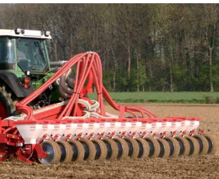
In Kombination mit einer Einzelkornsämaschine kann der Fronttank DF-2 zur Reihenhängung (bis zu 16 Reihen) eingesetzt werden
