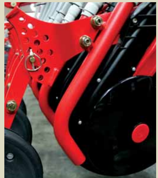
CX-II Schar mit doppelten Auslauf für die Saatgut- (schwarzer Auslauf) und Düngerausbringung (roter Auslauf) in einer Überfahrt.
