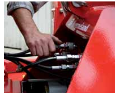
Schnittstelle für hydraulische und elektrische Verbindungen im Turm der Kreiselegge
