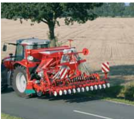
Die schweren Baugruppen (Tank und Kreiselegge) sind direkt hinter dem Traktor angeordnet.
