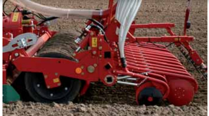
Direkte Verbindung zum Walzenrahmen und zur Scharschienaushebung (Option)
