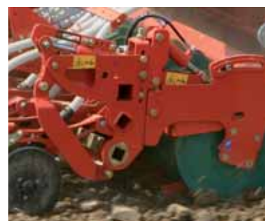
Die Scharschiene hängt direkt am Rahmen der Packerwalze
