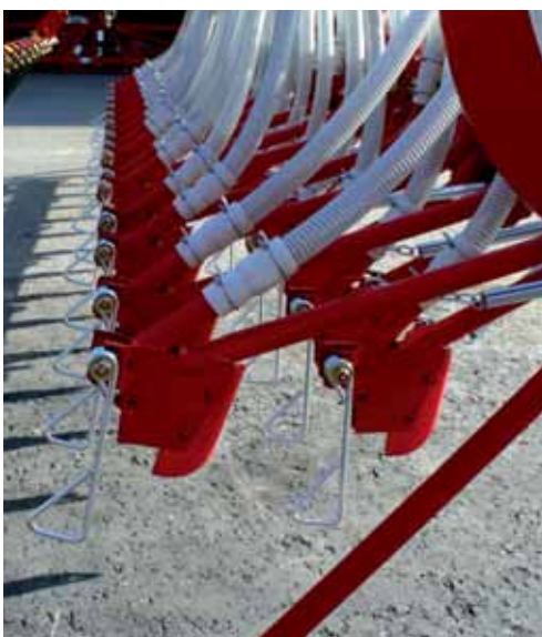
Schleppschar mit doppelten Auslauf für Dünger- und Saatgutausbringung in einer Überfahrt.
