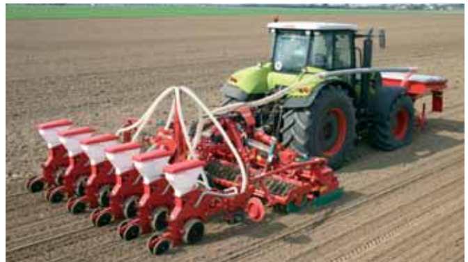
Der DF-1 Tank als Düngerbehälter bei der Einzelkornsaat bis zu 8 Reihen
