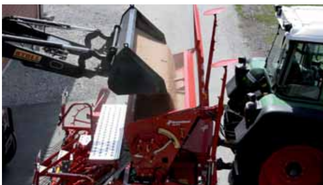
Mechanische Füllstandsanzeige des Saatguttanks
