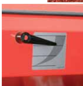
Mechanische Füllstandsanzeige des Saatguttanks
