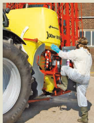
Saugfilter einfach kontrollieren und reinigen
