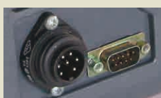
Serielle RS232 Schnittstelle für den Anschluss externer Elektronik
