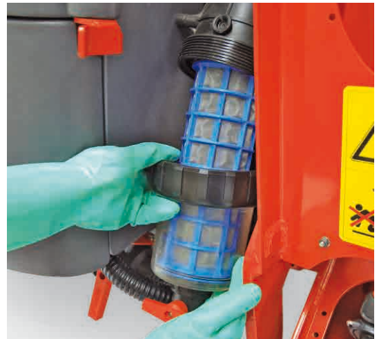
Saugfilter einfach kontrollieren und reinigen
