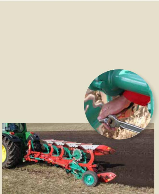
Einfache und schnelle Einstellung der Arbeitstiefe mit Y-Schrauben
