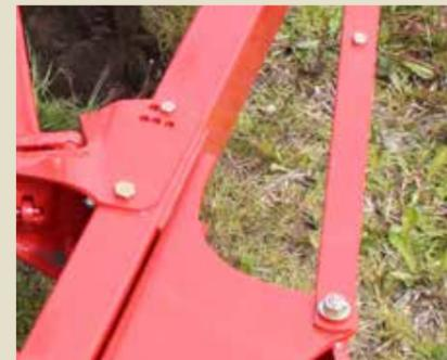
Manuelle Schnittbreitenverstellung in 5 cm Schritten
