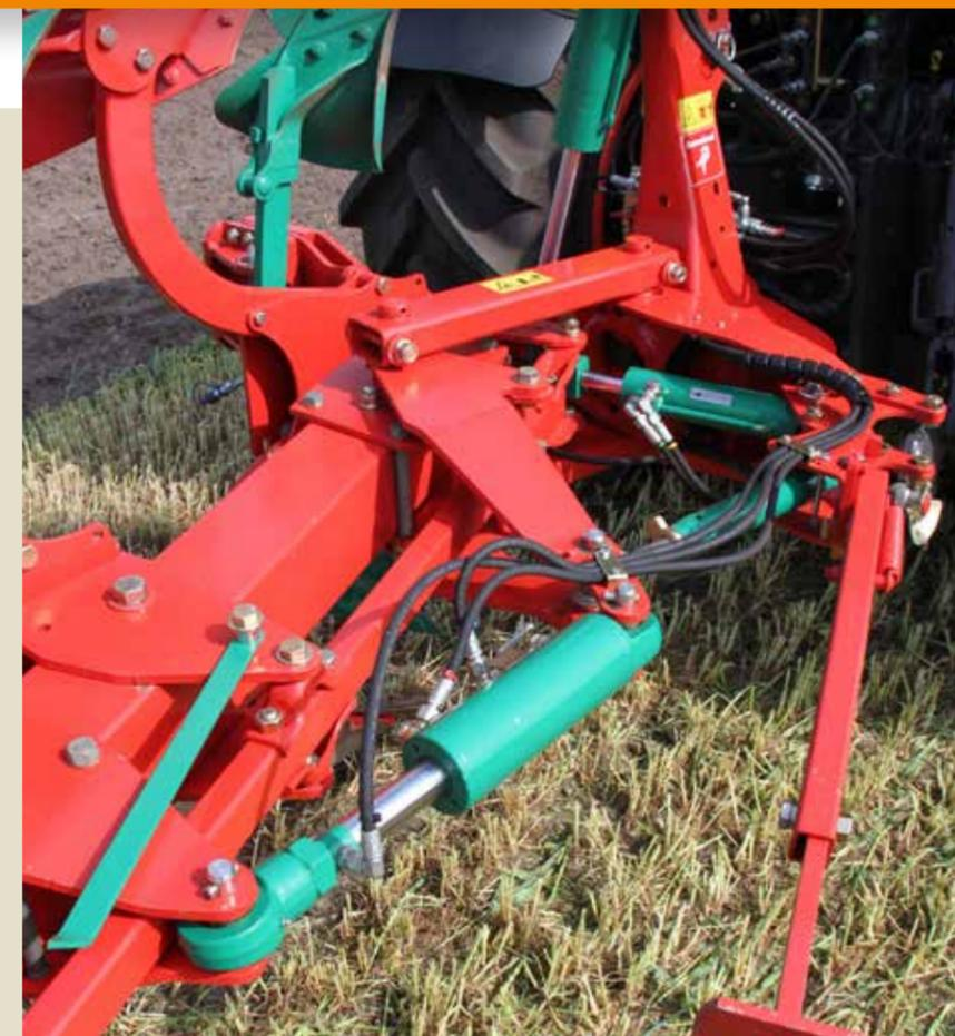
Parallelogrammführung mit Memoryzylinder und hydraulischer Vorderfurcheneinstellung
