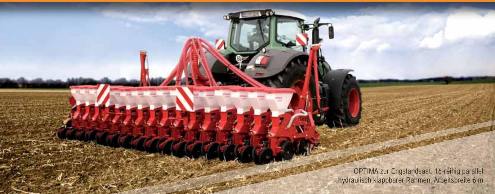
OPTIMA zur Engstandsmaat. 16-reihig parallel hydraulisch klappbarer Rahmen, Arbeitsbreite 6 m
