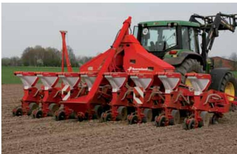
OPTIMA 8-reihig parallel hydr. klappbar, 6 m Arbeitsbreite, Zenträldüngerbehälter 900 l
