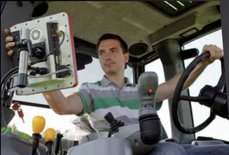
Der IsoMatch Tellus ist das erste ISOBUS Terminal weltweit, welches gesteigerte Hardwarekapazität mit zwei Displays in einem Gerät vereint. Er ermöglicht die komfortable Kontrolle zweier ISOBUS-Geräte, ohne blättern zu müssen.
