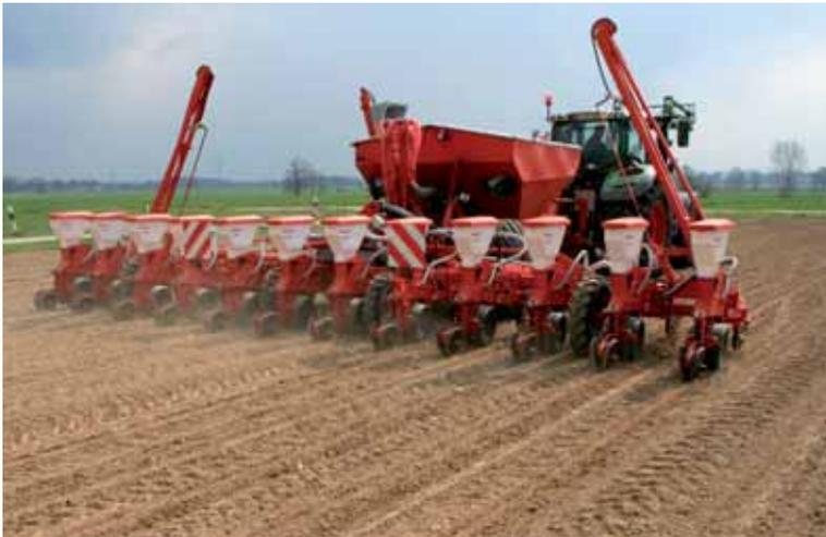
Für hohe Arbeitsleistung: 12-reihige hydraulisch klappbare Maissämaschine
