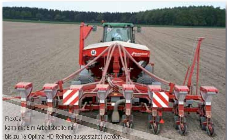
FlexCart kann mit 6 m Arbeitsbreite mit bis zu 16 Optima HD Reihen ausgestattet werden.
