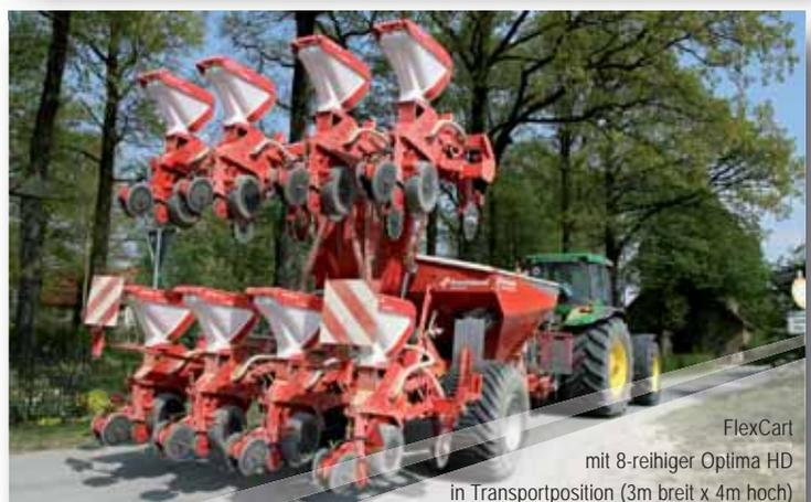
FlexCart mit 8-reihiger Optima HD in Transportposition (3m breit x 4m hoch)
