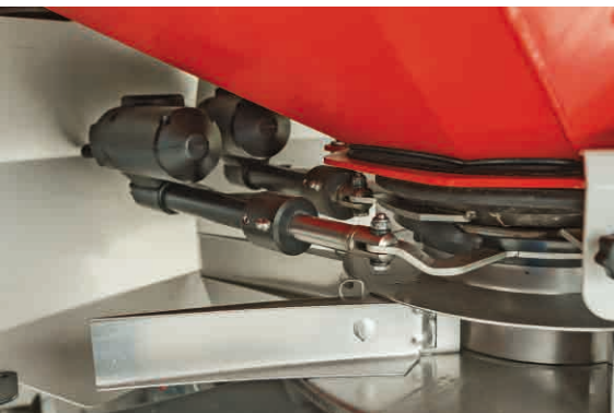
Zwei Stellmotoren auf jeder Seite steuern den Aufgabepunkt und die Ausbringungsmenge.
