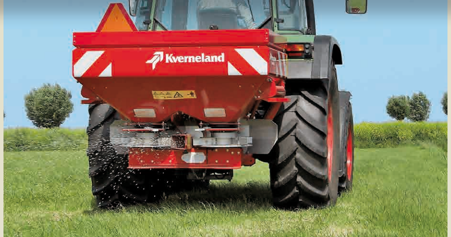
Grenzstreuen bei Verwendung der Grenzstreuplatte
