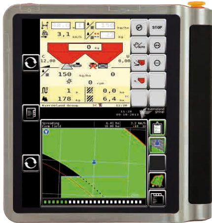
IsoMatch GEOcontrol - die Task Controller Software auf dem IsoMatch Tellus Terminal.
