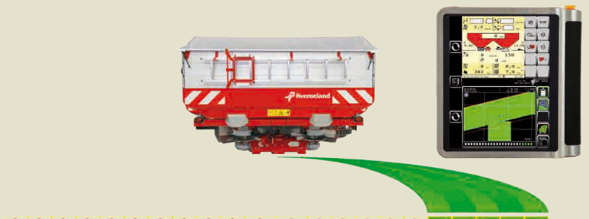
Von links nach rechts Teilbreiten abschalten über die Mitte hinaus
