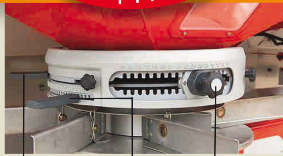
Feindosiersatz Dosieröffnung Ausbringmenge
