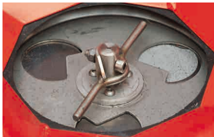
Langsam drehender Rührfinger
